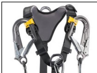
Los conectores MGO de los elementos de amarre anticaídas se pueden guardar en cada tirante. Así el elemento de amarre no molesta al usuario y los conectores permanecen al alcance de la mano. En caso de caída, este sistema permite el despliegue del absorbedor liberando los MGO.
