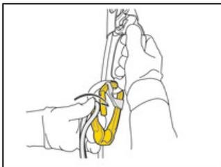
La polea ROLLCLIP A puede ser utilizada como punto de reenvío en el punto de conexión superior del puño bloqueador ASCENSION para realizar cortos ascensos por cuerda. La apertura del gatillo lado polea facilita la instalación de la cuerda.
