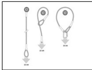
Ofrece varias configuraciones para instalar un amarre: directamente a un anclaje o alrededor de una estructura adecuada.
