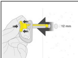
El anclaje se coloca y se retira fácil y rápidamente, sin herramienta, para ser reutilizado.
