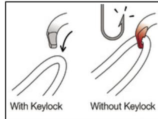
Para garantizar una eficacia óptima durante las maniobras, los mosquetones OK integran el sistema Keylock: sistema de unión del cuerpo y el gatillo sin muesca para evitar que el mosquetón se enganche involuntariamente al anclaje, la cuerda, el anillo portamaterial del arnés...
