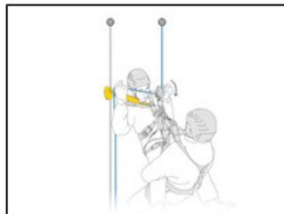
El ASAP'SORBER AXESS puede ser utilizado hasta 250 kg en el marco de un rescate con dos personas.
