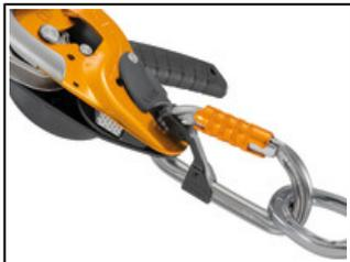
El mosquetón Am'D tiene una forma en D, asimétrica, idónea para la conexión de los aparatos del tipo descensores o elementos de amarre de sujeción. La utilización de la barra CAPTIV favorece la sollicitación del mosquetón según el eje mayor, limita el riesgo de volteo y lo solidariza con el aparato o con el elemento de amarre.
